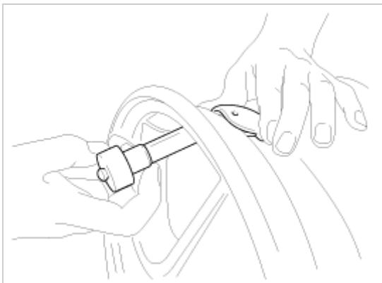
3. 继续拧紧螺母，拧紧 $3.5\text{~}4.5\text{Nm}$ ，直到接触到轮辋。
